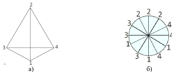
Рисунок 6 – Мікрофонна конфігурація: а) дельтоїдна; б) розташування пар конфігурації на кутовому діапазоні
