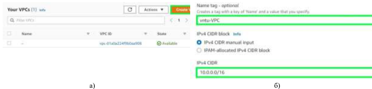
Рисунок 1 – Створення віртуальної мережі: а) – панель консолі AWS; б) – поля сторінки створення VPC
