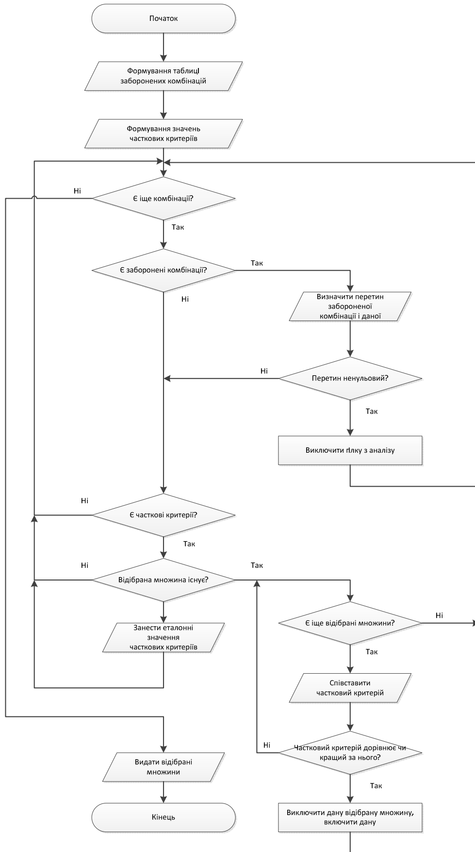
Рисунок 5 – Блок-схема роботи моделі компромісів за алгоритмом Парето
