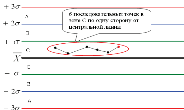
Рисунок 4 - Один из критериев разлаженности испытательного процесса
