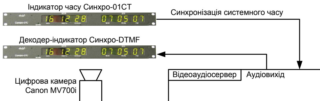
Рисунок 5 – Схема вимірювання абсолютної похибки визначення часу мовлення радіопередач декодером-індикатором „Синхро-DTMF”
