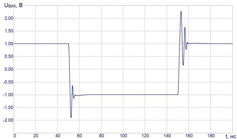
Рисунок 3 – Перехідна характеристика БН
