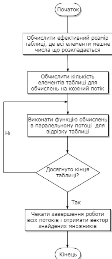
Рисунок 1 – Блок-схема алгоритму розподілення обчислень канонічного розкладу числа
