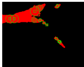
ж) Інструмент «Circle Detection» знаходження центрів кіл з радіусами в діапазоні 3 – 20 (пікселів)
