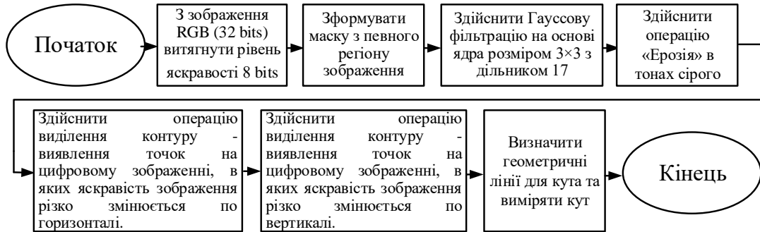
Рисунок 6 – Алгоритм комп'ютерної діагностики 2d ультразвукових зображень дисплазії кульшового суглобу з використанням інструмента
