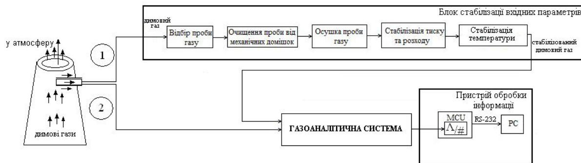
Рисунок 1 – Шляхи подачі димового газу на ГС, для його аналізу
